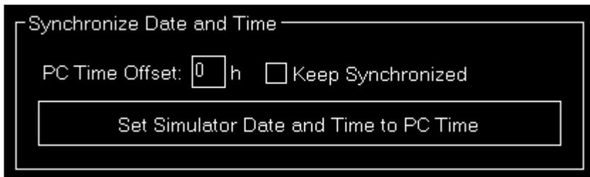
Es gibt darüber hinaus auch die Möglichkeit das Datum und die Uhrzeit des Simulators mit der des Computers zu synchronisieren, optional mit einem bestimmten Zeitversatz.
