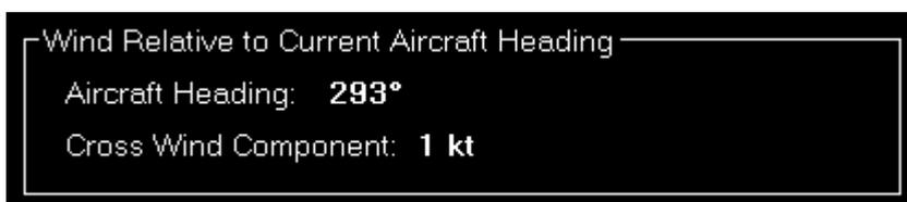
Dieser Bereich zeigt Ihre aktuelle Flugrichtung und berechnet die dazu relative Seitenwindkomponente.
