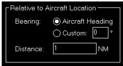
Wenn der Effekt relativ zur Fluggeräteposition platziert werden soll, müssen Sie zunächst auswählen, ob er in die aktuelle Flugrichtung oder in eine benutzerdefinierte Richtung platziert werden soll.
