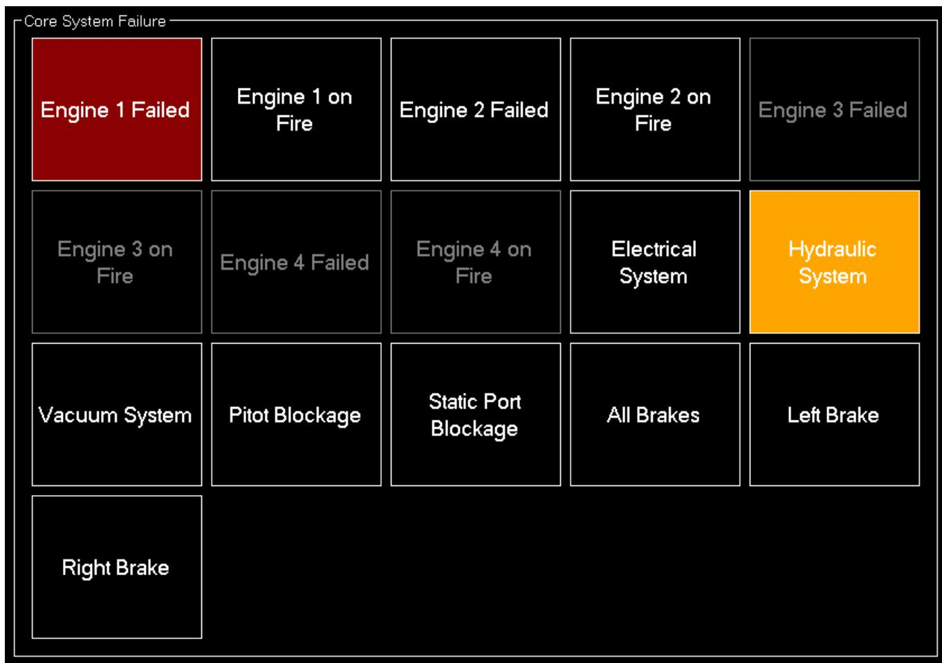
In diesem Bereich können Sie alle Hauptsysteme des Fluggerätes wie Triebwerke, das elektrische System oder die Bremsen ausfallen lassen.
