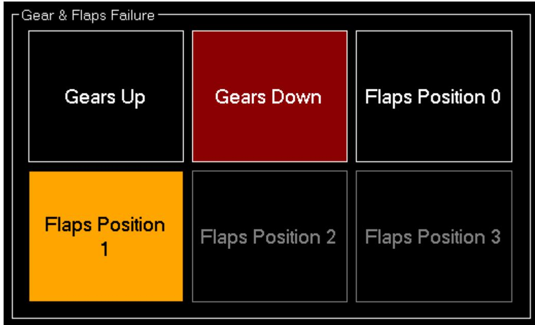
Hier können Sie das Fahrwerk und die Landeklappen des Fluggerätes in einer bestimmten Position feststecken lassen.
