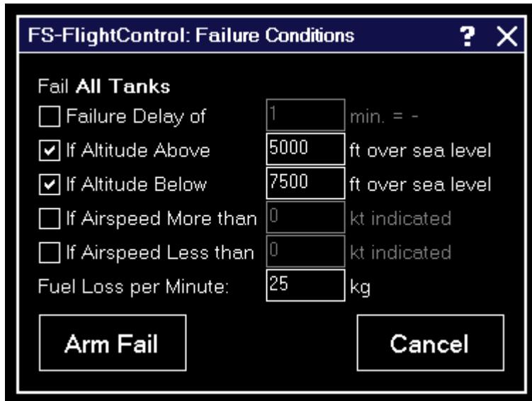
Nachdem Sie auf eine der Defektschaltflächen in den oberen Bereichen geklickt haben, wird dieser Defektbedingungs-Dialog angezeigt. Aktivieren Sie das Kontrollkästchen vor einer Bedingung, um diese zu aktivieren.
