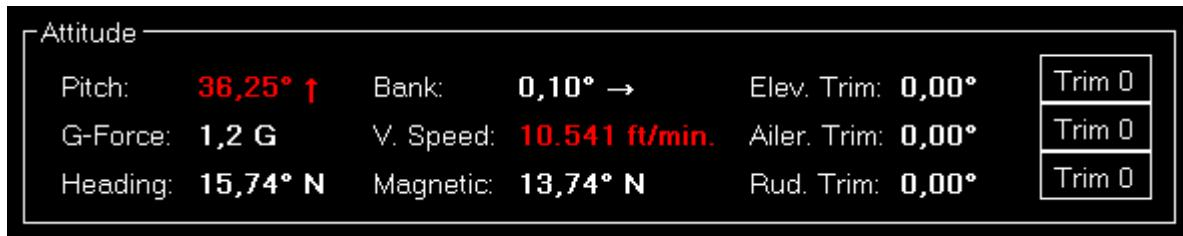
Hier wird die aktuelle Pitch- und Querneigung, die G-Kraft, die vertikale Geschwindigkeit, der Kurs und die Höhenruder-Trimmung angezeigt. Sie können das Höhenruder hier auch mit nur einem Klick zurück auf Null trimmen.
