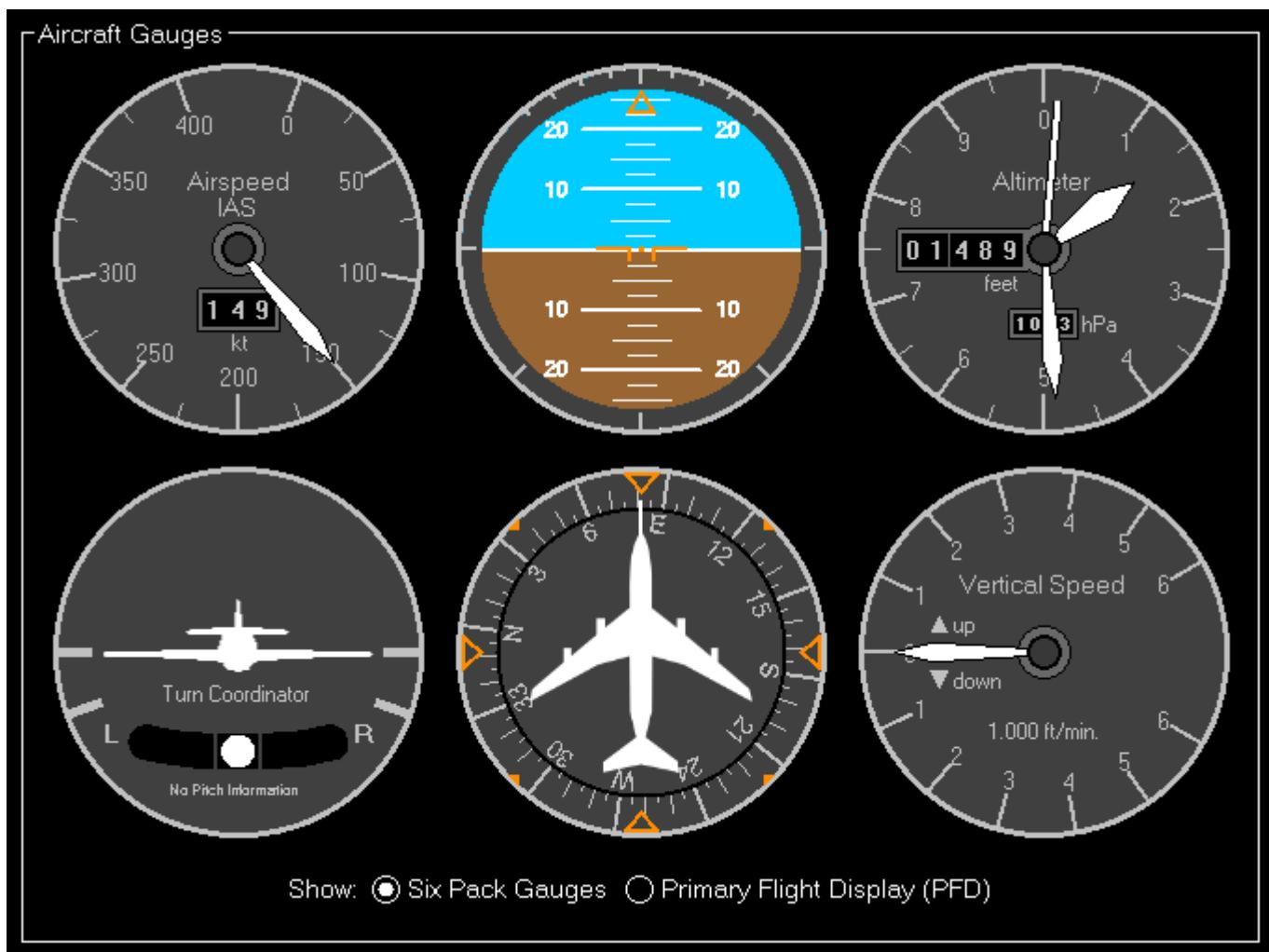
Hier werden die sechs Standard-Instrumente von Fluggeräten mit analoger Avionic angezeigt.
