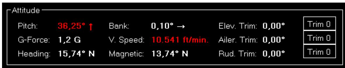
Hier wird die aktuelle Pitch- und Querneigung, die G-Kraft, die vertikale Geschwindigkeit, der Kurs und die Trimmungen angezeigt.
