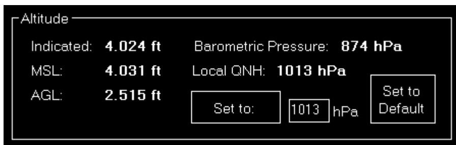
In diesem Bereich wird die aktuelle angezeigte Höhe, die Höhe über dem Meeresspiegel (MSL, Main Sea Level) sowie die Höhe über Grund (AGL, Main Sea Level) angezeigt.
