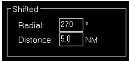
Optional ist es möglich die Warteschleife von diesem Punkt auf einem gewissen Radial um eine bestimmte Entfernung zu versetzen.
