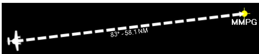
Wenn der erste oder letzte Punkt eine bewegliches Objekt (wie das Benutzer- oder ein AI-Flugzeug) ist, bewegt sich der Messpfeil zusammen mit den Objekten und wird entsprechend aktualisiert. Zusätzlich wird die Dauer bis zum Ziel basierend auf der Bodengeschwindigkeit des ersten Objektes angezeigt.
