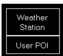
**Weather Station** schaltet die Anzeige der Wetterstationen ein und aus. Im teilweise aktiven Status werden nur die Wetterstationen selbst angezeigt und im vollständig aktiven Status zusätzlich die Wetterstationen-ICAO-Codes.
