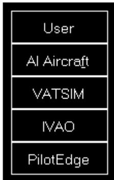
User schaltet die Anzeige des Benutzer-Fluggerätes ein und aus. Im teilweise aktiven Status wird nur das Fluggerät selbst angezeigt und im vollständig aktiven Status zusätzlich die aktuelle Höhe als Flugfläche sowie die angezeigte Geschwindigkeit und der wahre Kurs, unterteilt mit einem T in der Anzeige.
