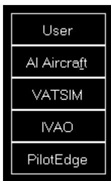
User schaltet die Anzeige des Benutzer-Fluggerätes ein und aus. Im teilweise aktiven Status wird nur das Fluggerät selbst angezeigt und im vollständig aktiven Status zusätzlich die aktuelle Höhe als Flugfläche sowie die angezeigte Geschwindigkeit und der wahre Kurs, unterteilt mit einem T in der Anzeige.
