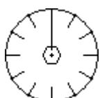
Dies zeigt ein VOR (VHF Omnidirectional Radio Range, Drehfunkfeuer).
