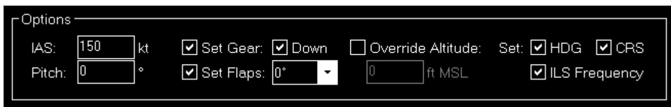
Hier finden Sie verschiedene Optionen wie Geschwindigkeit und Fahrwerk-/Klappenstatus, die verwendet werden, wenn Ihr Fluggerät platziert wird.
