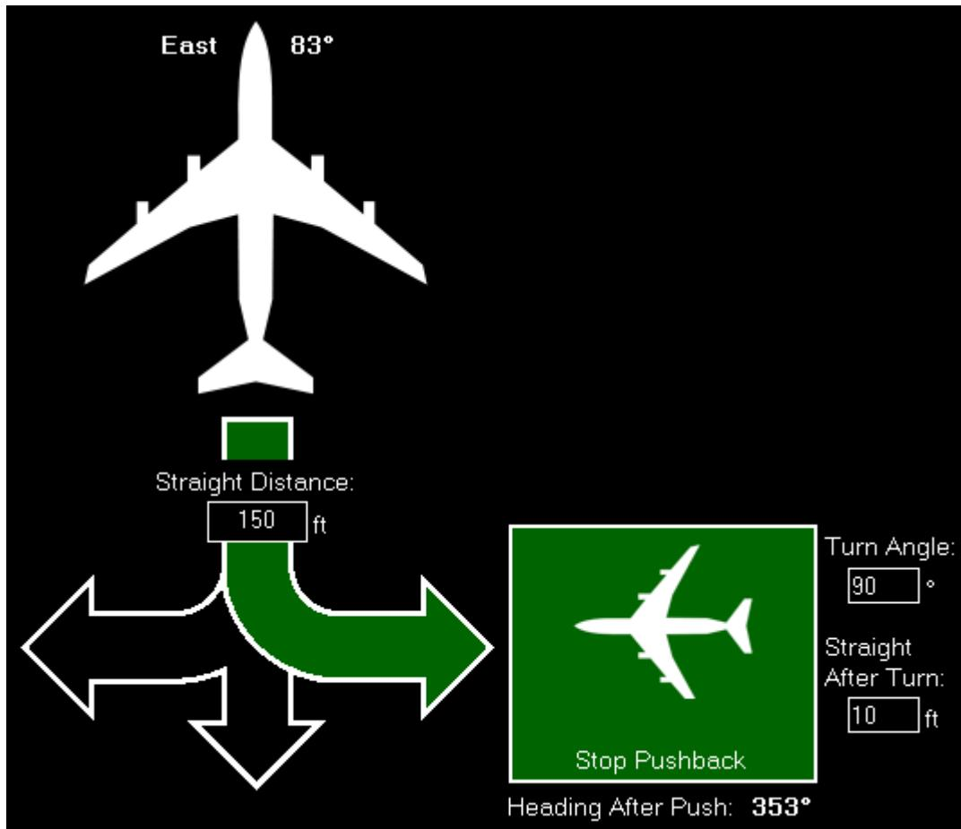
Der Pushback-Vorgang stoppt automatisch, nachdem die eingestellte Entfernung und, im Falle eines Pushbacks nach links und rechts, die Kurve inklusive der darauf folgenden geraden Entfernung erreicht ist.
