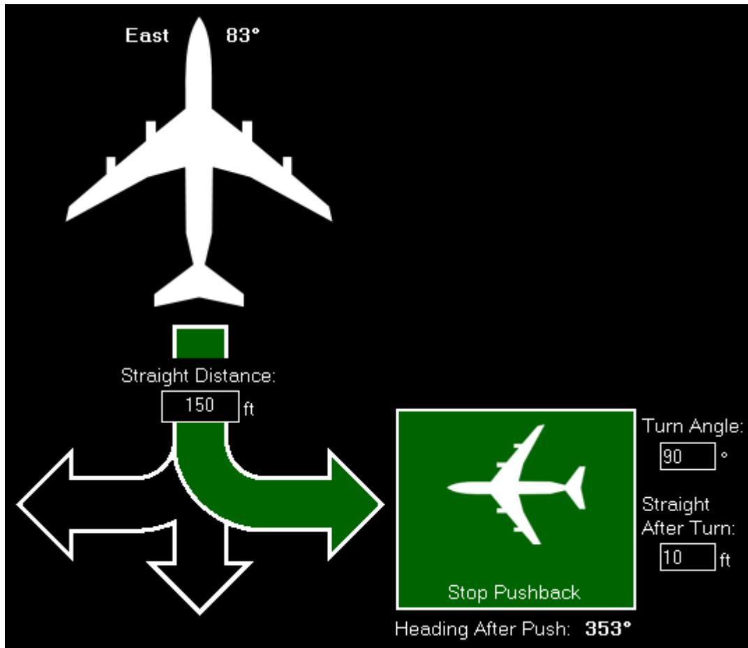
Der Pushback-Vorgang stoppt automatisch, nachdem die eingestellte Entfernung und im Falle eines Pushbacks nach links und rechts, die Kurve inklusiv der darauf folgenden geraden Entfernung erreicht ist.
