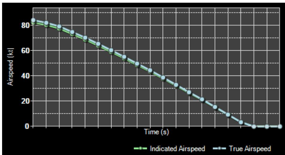
Das erste Diagramm stellt die aktuelle angezeigte und wahre Luftgeschwindigkeit dar.
