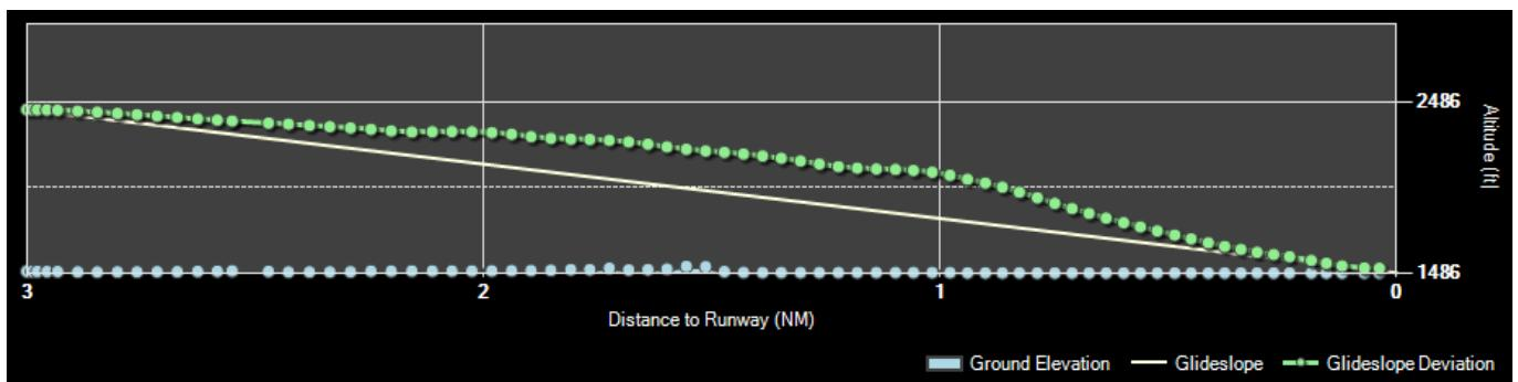
Im unteren Diagramm wird die aktuelle Flughöhe über Meeresspiegel (MSL) sowie die Geländehöhe angezeigt.
